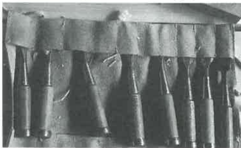
仕事道具。鑿。柱の模様を彫るために使う。すべての鑿の先端をしまっていて安全を心がけている。
